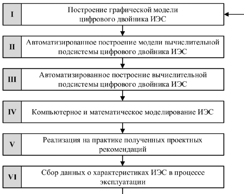
Рис. 3. Этапы методики решения задачи проектирования интегрированной энергетической системы на основе ее цифрового двойника.
