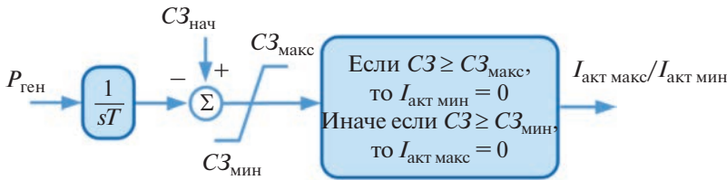
Рис. 6. Контур заряда-разряда в обобщенной модели АБ.
