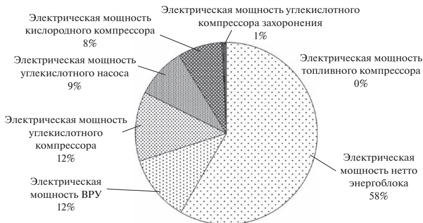
Рис. 8. Затраты электрической мощности брутто в энергоблоке на основе цикла Аллама.
