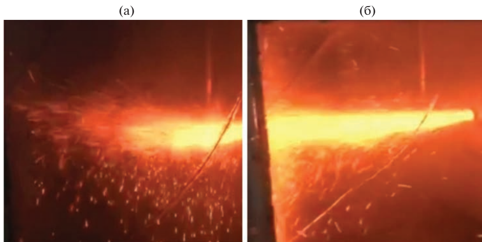
Рис. 6. Структура факела при сжигании продуктов предварительной термической обработки полифракции бородинского угля: (а) – температура предварительной обработки T_{\text{тп}} = 600^\circ\text{C} ; (б) – T_{\text{тп}} = 800^\circ\text{C} . Длительность термообработки составила \tau_{\text{тп}} = 0.5 с.
