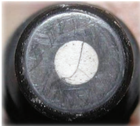
Рис. 6. Трещина в твердом электролите ДАК-45 не приводит к разрушению и потере герметичности.
